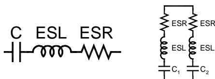
Figur 14. Ekvivalenta kretsar för en ensam kondensator respektive två parallellkopplade kondensatorer.
